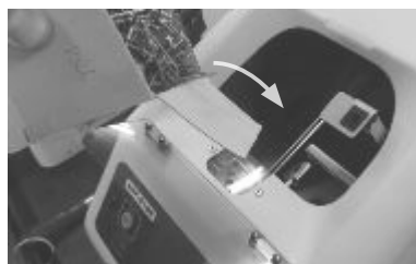
リベット投入
